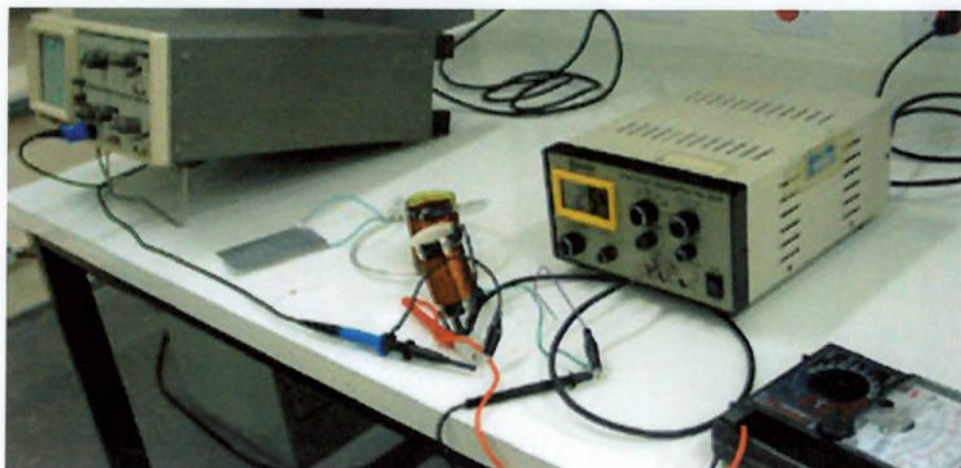
Figura 16 – Osciloscópio e Multímetro Ligados à Antena
